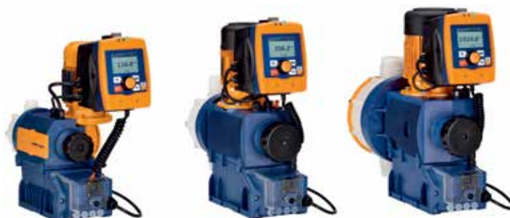
Mambranowe pompy dozujące o napędzie silnikowym sigma X Control Zakres wydajności: 21 – 1040 l/h 16 – 4 bar
